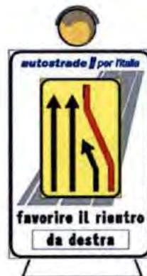
Figura 5: pannello composito di presegnalazione in destra modificabile con lamierini integrato con lampeggiatore a led alta efficienza diam. 300 mm alimentato con batteria da autovettura. Dimensioni 135x200 cm. Posizionamento sul margine destro su cavalletto con anticipo rispetto al cartello "lavori in corso" come da schemi in cui se ne prevede la dotazione.
