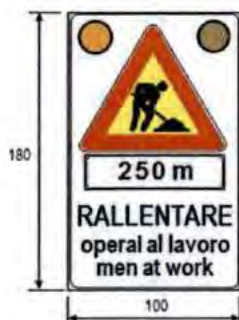
Figura 1: cartello su cavalletto con lampeggiatori diam. 200 mm ad alta efficienza
