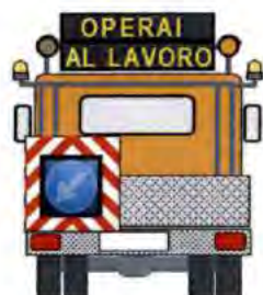
Figura 7: esempio di autocarro con PMV allanumerico e disco direzione obbligatoria interamente a led.
