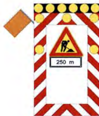
Figura 14: "segnale mobile di preavviso" derivato dalla fig. Il 400 Art.39 Reg. da impiegare per lavori sulla sola corsia di emergenza. E' integrato con set di 6 lampade a led ad alta efficienza luminosa diam. 300 mm (con possibilità di lampeggio sincrono e sequenziale) e con sbandieratore elettromeccanico posto in alto sul lato esposto al traffico.
